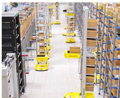
Figura 3. Esempio di AMR utilizzato nell’intralogistica. Fonte: Dossier logistica, La rivoluzione degli AMR (2025).
