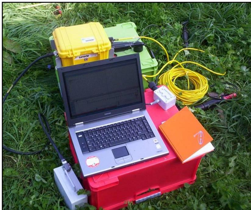
**Figura 2:** Strumentazione utilizzata per la prova MASW.
