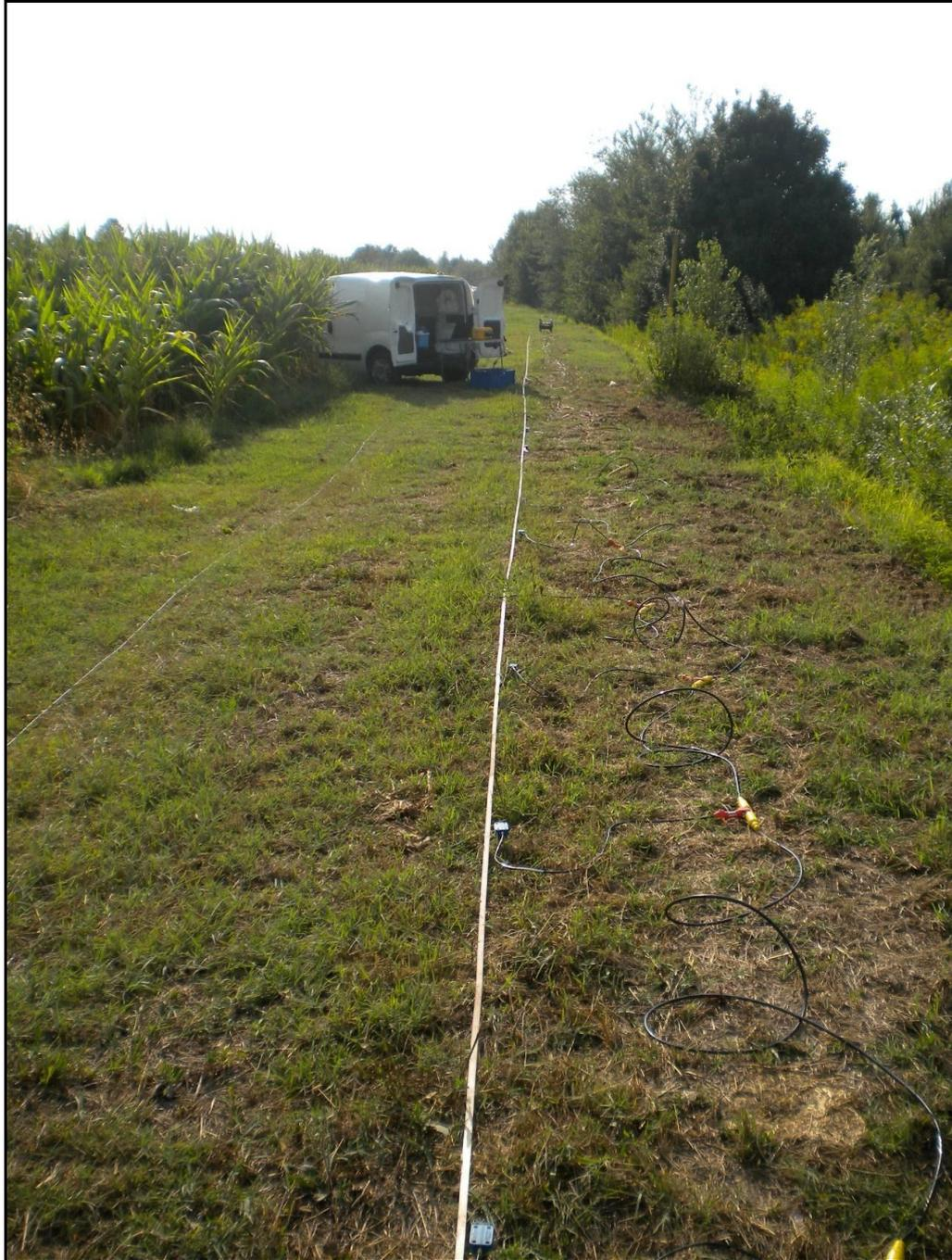
**Figura 3:** Vista dello stendimento MASW effettuato.
