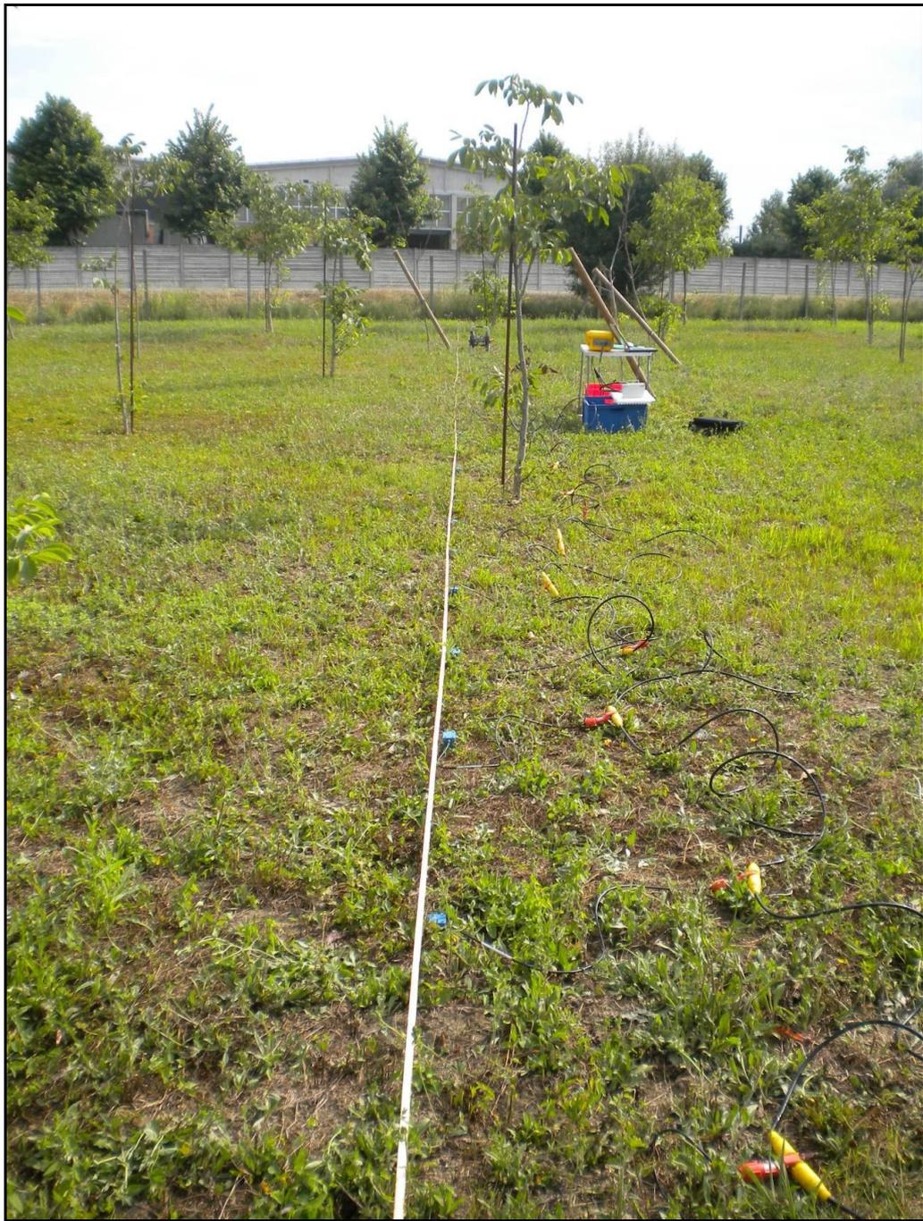
**Figura 3:** Vista dello stendimento MASW effettuato.
