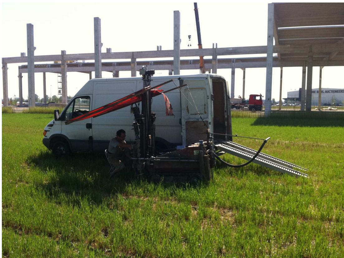
*Dettaglio delle prove penetrometriche statiche CPT effettuate*
